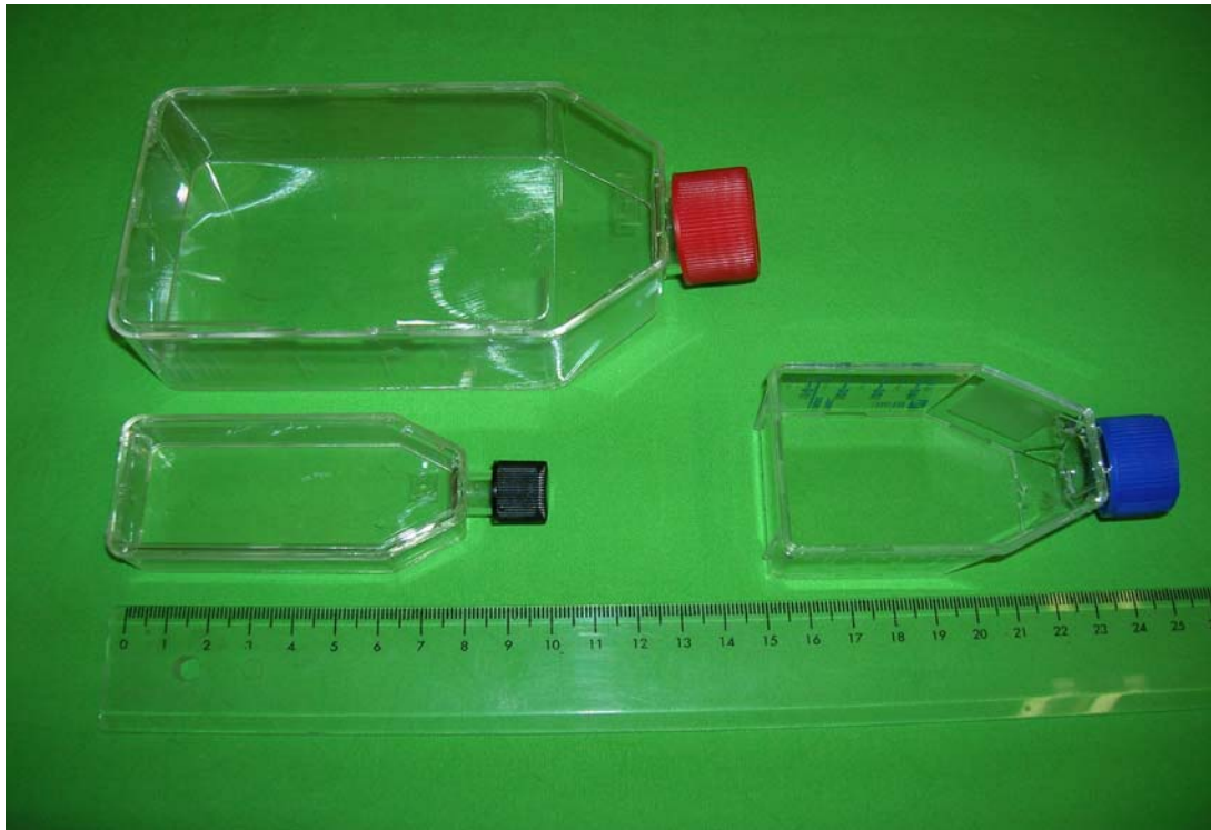
34. ábra Sejttenyésztő „flaskák”. A tenyésztőfelszín nagyságában, a sejtfilm felett lévő folyadékréteg térfogatában térnek el egymástól.
