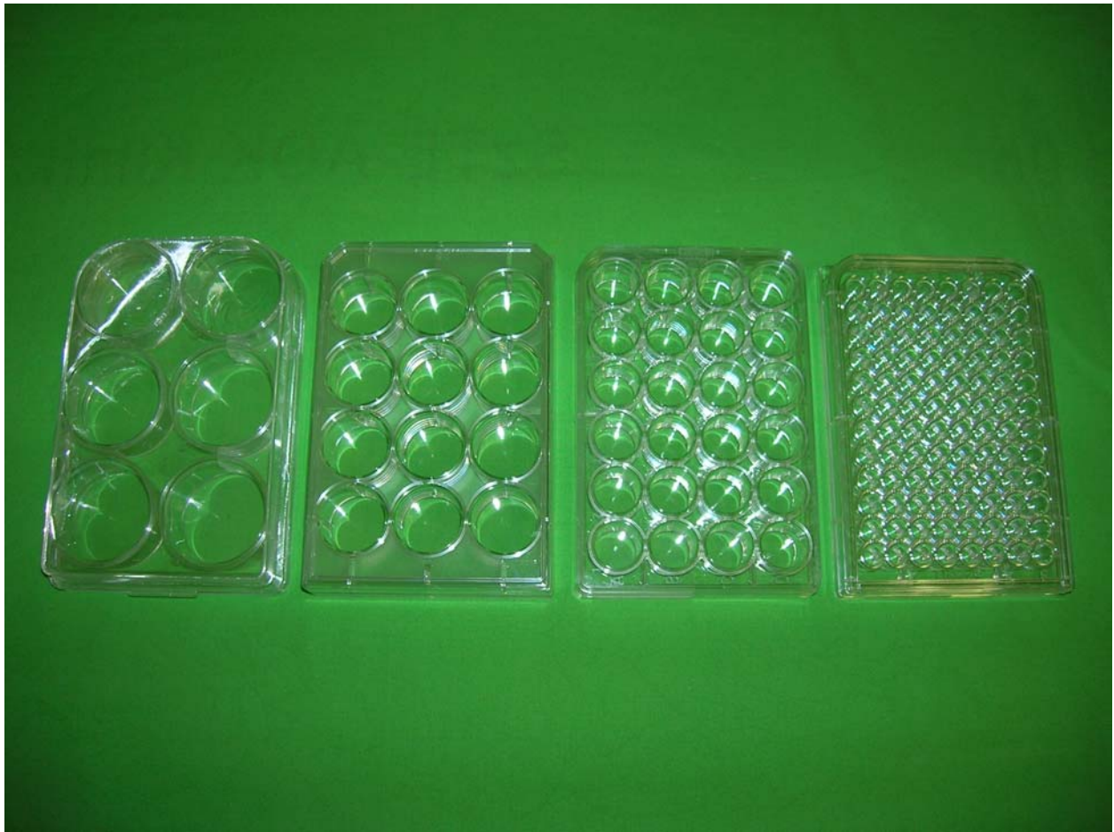
36. ábra Soklyukú tenyésztőedények. Több kútban, azonos körülmények között növekedő, párhuzamos minta vizsgálatát teszik lehetővé. A tenyésztőkutak száma 6, 12, 24, 48 ill. 96 lehet.
